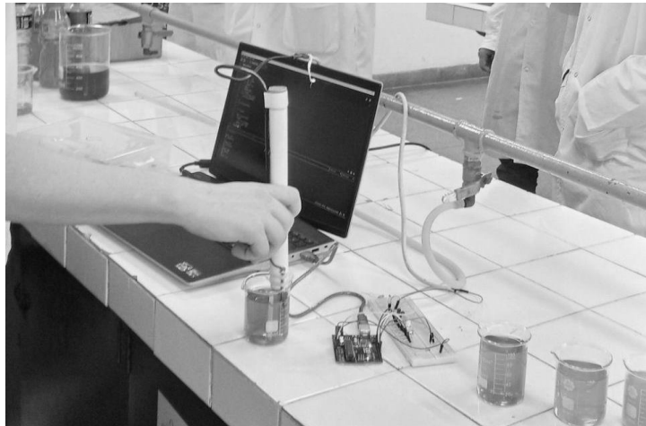
Figura 1. Medición de conductividad eléctrica de soluciones isotónicas, con sonda y circuito desarrollado por estudiantes.
