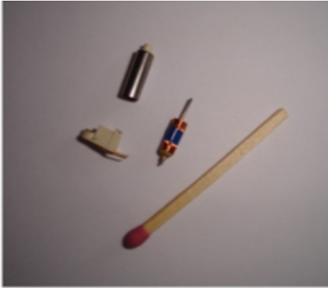
Desarme de motor de teléfono celular (vibrador)
