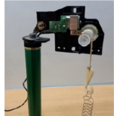
Dispositivo elevador para el cálculo del trabajo (con motor de impresora multifunción)
