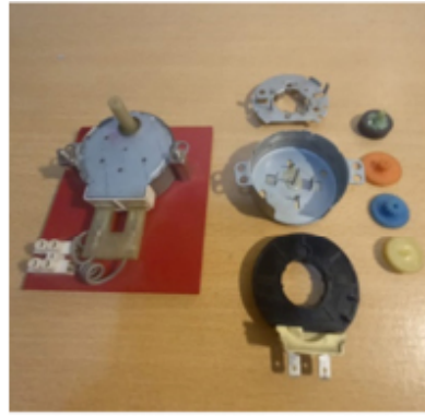
Motores sincrónicos de microondas. Despiece para el trabajo
