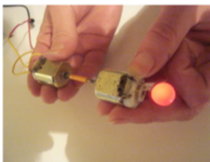
Armado de motor- generador sencillo con led
