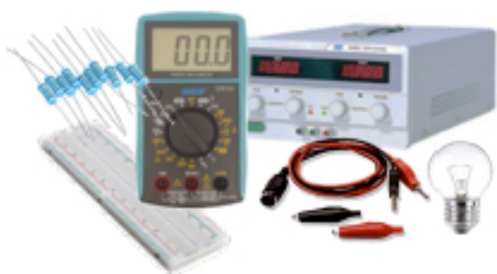
Figura 1. Laboratorio Modalidad Presencial. Multímetro digital, fuente de alimentación, protoboard, resistencias, lámpara incandescente, conectores. Fuente: Elaboración Propia.
