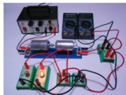
Un montaje eléctrico para la caracterización del sistema motor – generador
