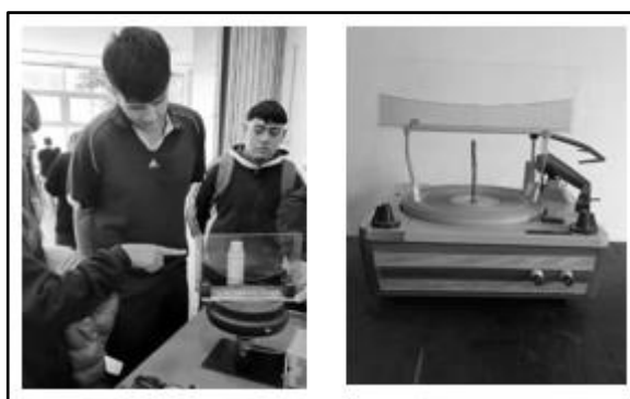
Figura 3: Izq. Aparato construido con el motor de ventilador y su uso con el público Der. Parábolas obtenidas en clase con dos velocidades angulares (45 y 78 RPM).
